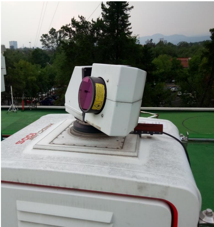
Fig. 4. Cabezal láser del perfilador de viento.
